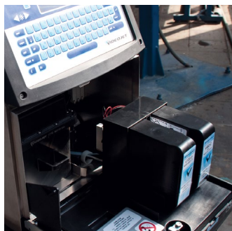
System dostarczania płynów Smart Cartridge™ w drukarce Videojet 1710
