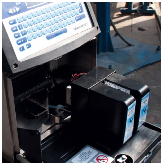
Sistema de dosificación de fluidos Smart Cartridge™ en el nuevo codificador Videojet 1710
