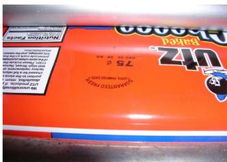
热转印打码机的打印头和色带与柔韧性材质接触，然后创建实时图像，包括整洁的高分辨率条码、文字和图形。对于伍兹而言，任何一台产品打码设备必须非常可靠耐用，在生产一致的可读编码的同时满足高速生产线的的需求。而伍兹使用的烫印机无法满足此需求，这也是 Epley 率先引进热转印打码机的原因。
