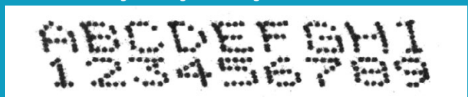
Videojet-Hochgeschwindigkeitscode mit optimierter Tropfenpositionierung
