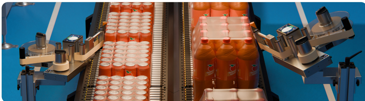
Configuration en double voie, application latérale
