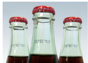
Coding above the fill line
