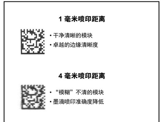
激光打码机具有TIJ喷码机所不具有的一些优点，表现在聚焦镜头和材质之间的距离以及产品放置的允许变化这两方面。一个典型的包装箱喷码应用可能需要100毫米的焦距，相对其标称的标识位置，包装位置的允许公差为 $\pm 3$ 毫米。此公差增量为物料搬运提供了一些安全裕度。
