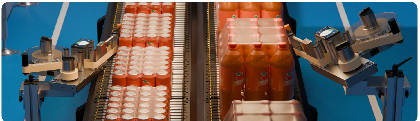
Configuración de doble carril y aplicación lateral
