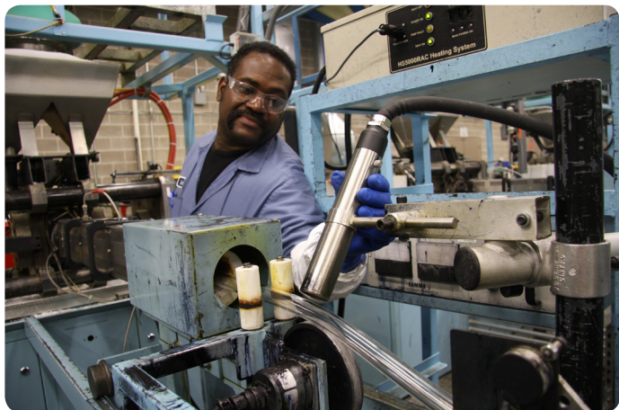
Mark Morgan, operator zatrudniony w firmie Uponor, reguluje głowicę drukarki atramentowej do druku ciągłego Videojet 1620.
