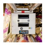
Selly Belly 当初、Jelly Belly 社ではチタンプレートを使用したホットスタンプ式のプリンタを使用していました。生産量の増加にともない、Jelly Belly 社は、生産ラインを高速で稼働させながら、必要な全ての情報が印字できて、リードタイムの短縮と切り替えの簡略化もできる新しい技術について検討を始めました。また、顧客からのカスタム印字ができることもソリューションの条件でした。
