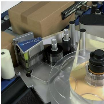
当包装仍沿着输送机中心线运行时，伟迪捷包装输送套件可提供两条可调导轨，安装在 LPA 贴标工位前，从而将包装导向输送机的一侧，为实现直接贴标做好准备。
