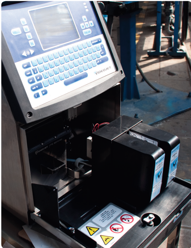
ระบบส่งผ่านของเหลว Smart Cartridge™ ในเครื่องใส่รหัส Videojet 1710 ตัวใหม่ของ Baosheng
