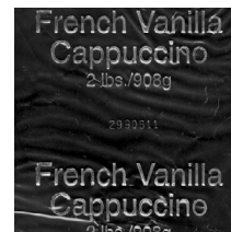
Espacio desperdiciado por Hot Stamping (6 mm entre huellas)
