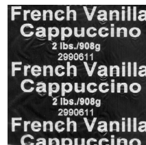
Cinta Ribbon codificada por TTO con máxima optimización del espacio (0,5 mm entre huellas)
