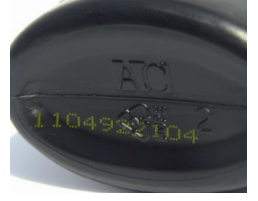
Koyu renkli plastik üzerinde CIJ kodu
