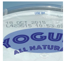
งานพิมพ์ด้วยระบบ CIJ บนผลิตภัณฑ์โยเกิร์ต
