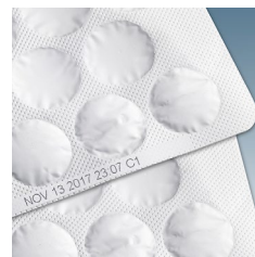
PTP 用アルミ箔へのサーマルインクジェットプリンタによる印字
