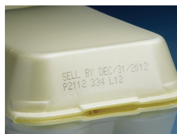
Inyección de tinta en cartón de huevos de poliestireno
