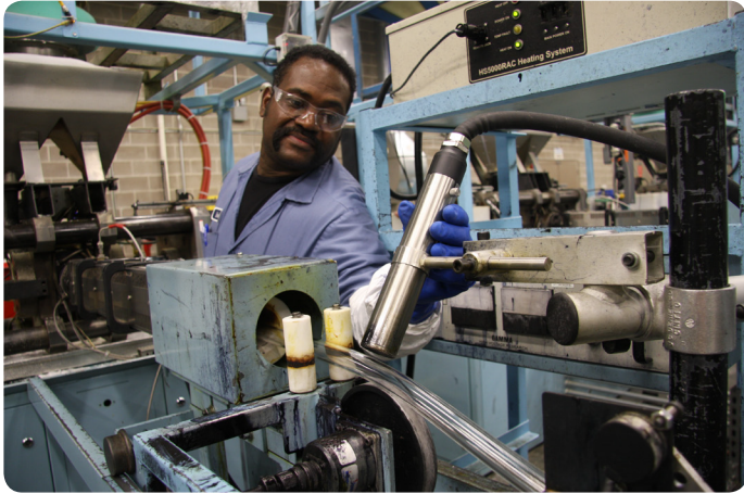
El operador de Uponor Mark Morgan ajusta el cabezal en la codificadora de inyección de tinta continua Videojet 1620.
