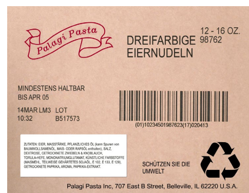
Karton mit vorgedrucktem Farblogo und vorgedruckter Liste der Inhaltsstoffe kombiniert mit variablem bedarfsgesteuertem Druck
