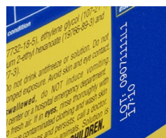
レーザーマーカ-によるペーパーラベル上の印字
