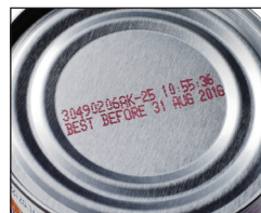
CIJ sobre una lata metálica
