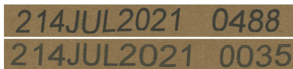
Gonnella 包装箱上的编码来自伟迪捷墨水 M533(上)和 M512(下)。
