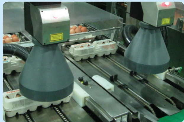
Láseres instalados en la línea de cartones
