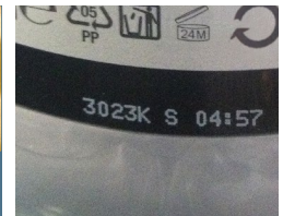
Código CIJ con tinta blanca en un desodorante
